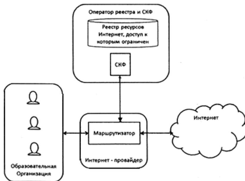
Рис.5. Схема работы контент-фильтрации при едином решении
